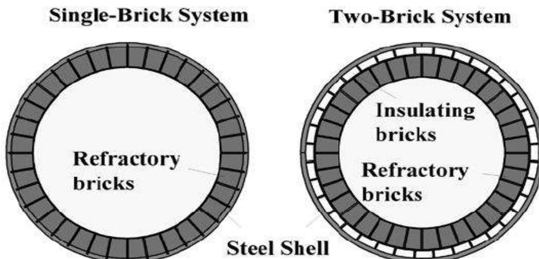
**Figure 5 Brick Lining In Lime Kiln**
