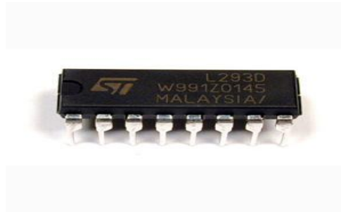
Fig: 4 l293d driver IC
