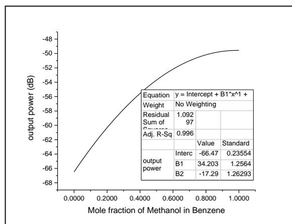
Fig. 5: Mole Fraction of  $\text{CH}_3\text{OH}$  in  $\text{C}_6\text{H}_6$
