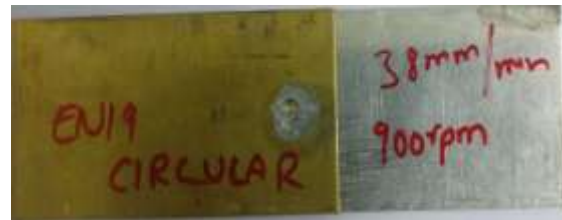
Fig 2:- FSSW of Al(6061-T6)to Brass(IS319) Brass(IS319) to Al(6061-T6)
