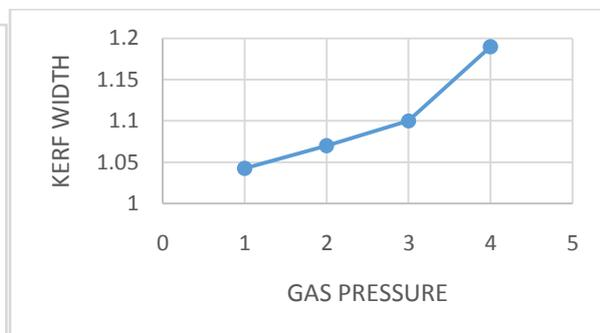
Fig. 8 Kerfwidth vs GAS PRESSURE
