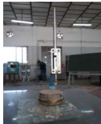
Fig.(1-b) Vicat Apparatus
